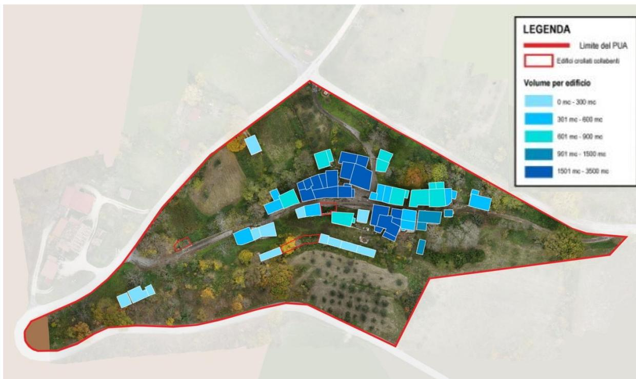
Planimetria di rilievo dello stato dei luoghi: Calcolo dei volumi
