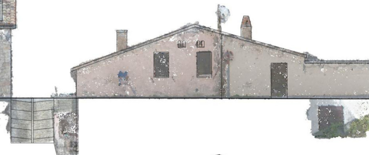
Via superiore principale: Strada Comunale Monastero - S.Liberato Restituzione dei prospetti degli edifici antistanti la pubblica via, mediante elaborazione dati da nuvola di punti rilevati da drone
